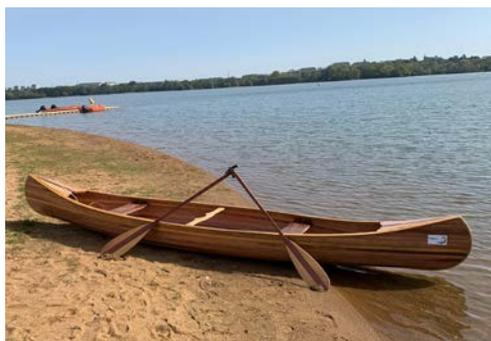
Quant au canoë, construit à l'envers sur un gabarit (sorte de squelette ou dinosaure selon les usagers) composé de 17 couples, il mesure 4,90 m par 90 cm au maître bau (partie la plus large). Il est assemblé entièrement en bois à partir de petites lattes bouvetées et en red Cedar de 6mm d'épaisseur pour 20 et 30 mm de large. Ces lattes sont emboîtées, collées, stratifiées et résinées les unes aux autres à l'époxy. Le gabarit est enlevé une fois la stratification extérieure réalisée.
